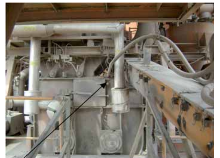
Injectie van de hars in de menger.
