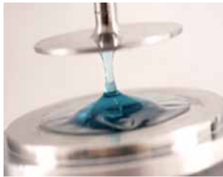
Bepaling rheologie (stijfheid en flexibiliteit van bitumen in bepaalde temperatuurfase) en viscositeit (omhulbaarheid en verwerkbaarheid van bitumen bij temperatuurfase).
