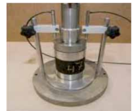
Triaxiaalproef: bepaling weerstand tegen spoor- en ribbelvorming.
